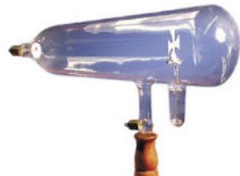
Figura 2.16 Tubo de Crookes usado por J. J. Thomson en uno de los experimentos efectuados para descubrir el electrón.
