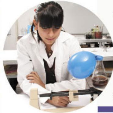
Figura 1.87 Procura que el globo que contiene el bicarbonato de sodio se ajuste bien a la boca del matraz, para evitar la pérdida de materia durante la reacción.
