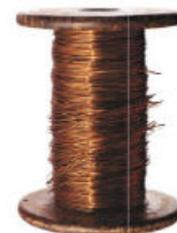
Figura 2.34 El cobre es uno de los metales más dúctiles. Los alambres se utilizan en instalaciones eléctricas.
