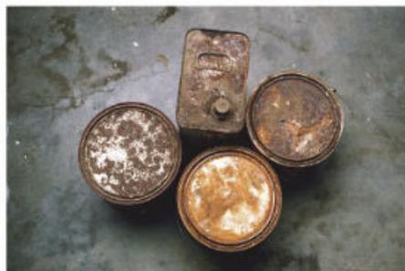
Figura 4.37 La sustancia rojiza que se forma en las latas es el resultado de una reacción de oxidación.
