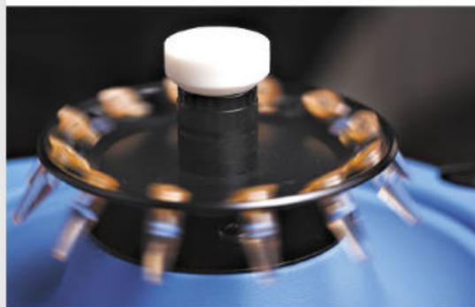
Figura 1.68 Centrífuga girando con muestras en viales o tubos
