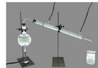
Figura 1.62 Dispositivo para hacer una destilación
