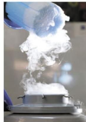
Figura 2.72 El nitrógeno es líquido a  $-195.8^{\circ}\text{C}$  y 1 atm de presión. En la imagen se ve un contenedor con nitrógeno líquido, que se está abriendo. Inmediatamente pasa a estado gaseoso.
