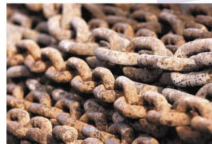
Figura 4.62 Ejemplo de corrosión superficial. En este caso las cadenas pierden masa gradualmente, pero siguen resistiendo.
