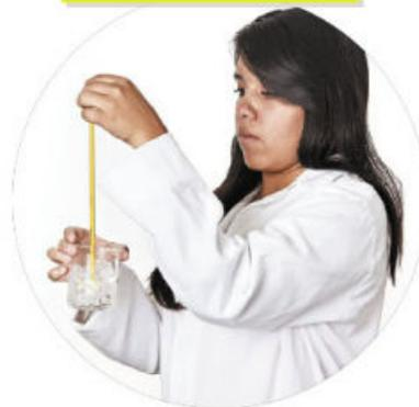
Figura 1.20 Es importante que al leer el termómetro, tengan la escala del termómetro a la altura de los ojos, para evitar el error de paralaje.
