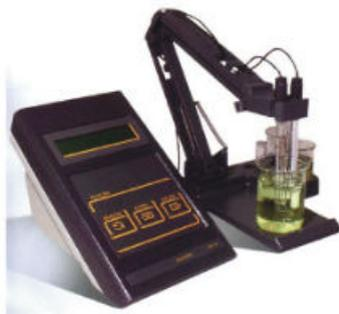
Figura 4.9 El pH-metro se debe calibrar antes de utilizarse para asegurar la exactitud de los datos.
